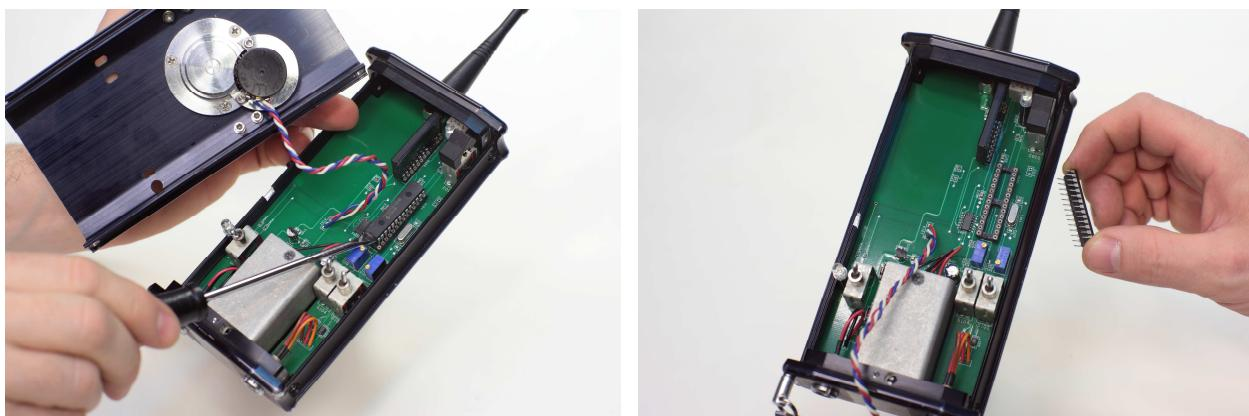
5. 아래에 보여지는 것과 같이 **BarTech Iris Slider PCB** 안에 U101 의 IC 연결장치를 신중하게 장착 하시오. 주의: 사진과 같이 정확하게 장착되지 않을 수도 있다.
